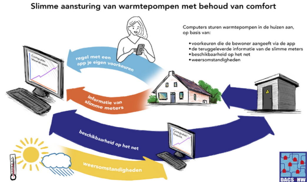
Figuur 23: Werkingsprincipe van slimme aansturing van hybride warmtepompen met behoud van comfort
